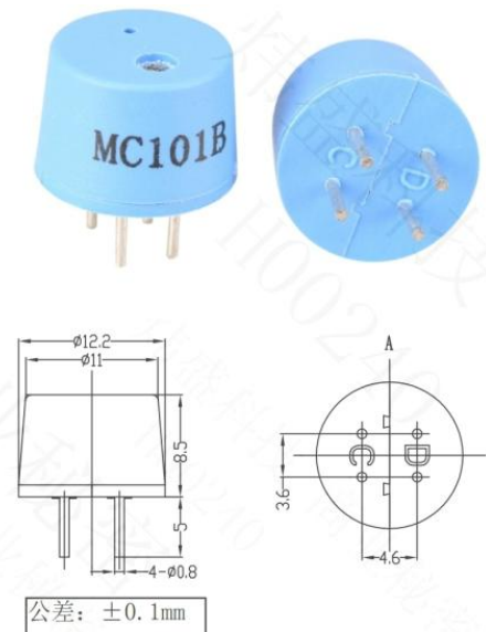
图 1：传感器外形结构图
